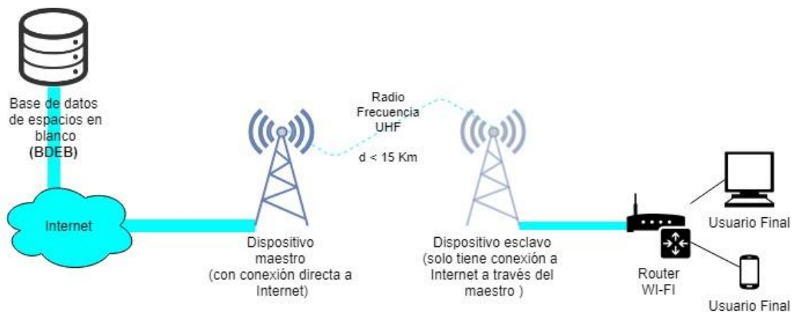
Figura. 2.5. Topología de un sistema TVWS basado en [19].
