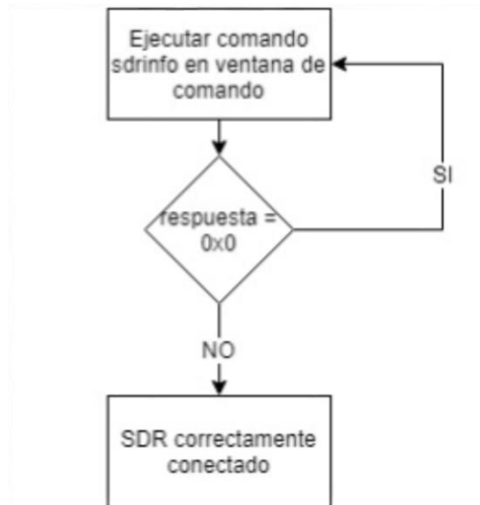
Figura. 3.5. Diagrama de flujo para la verificación de conectividad del RTL-SDR.
