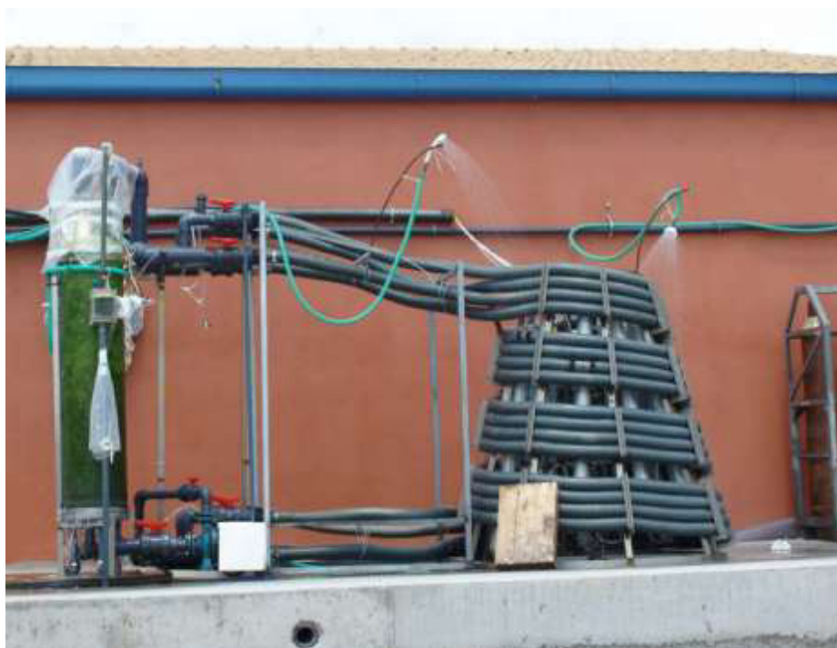
Ilustración 2.5 Fotobiorreactor tubular helicoidal (Briassoulis et al., 2010)
