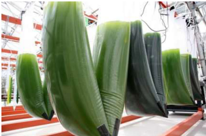
Ilustración 2.4 Fotobiorreactor vertical – bolsas, fotografía tomada en “ExxonMobil’s greenhouse” ubicado en La Jolla, California.
