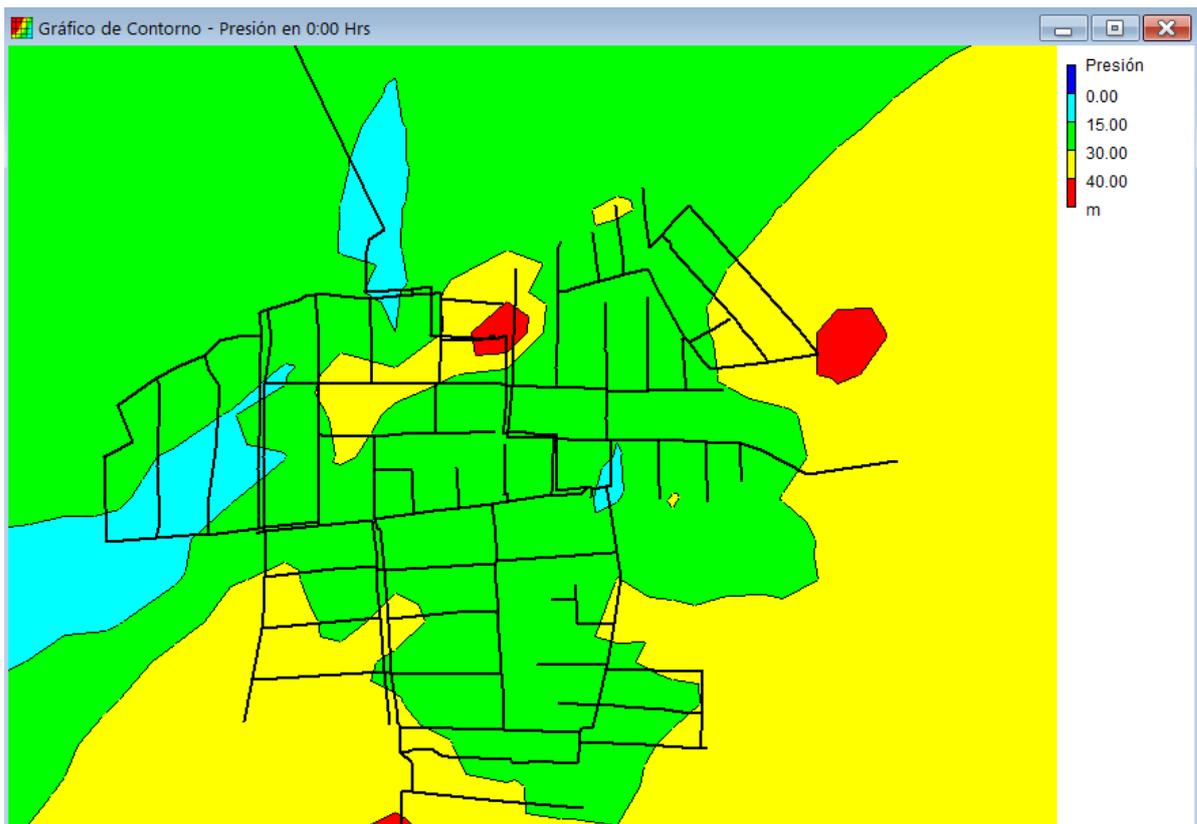
**Ilustración 3.60** Mapa de presiones con caudal de diseño con implementación de VRP
