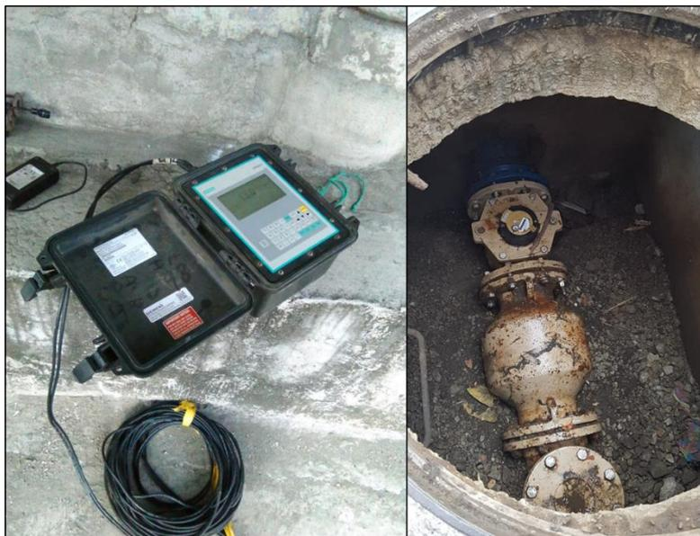
**Ilustración 2.15** Data-logger para control y medición de presiones y caudales.
