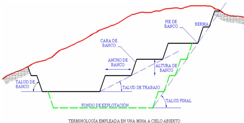
**Figura 1.10** Terminología empleada en una mina a cielo abierto
