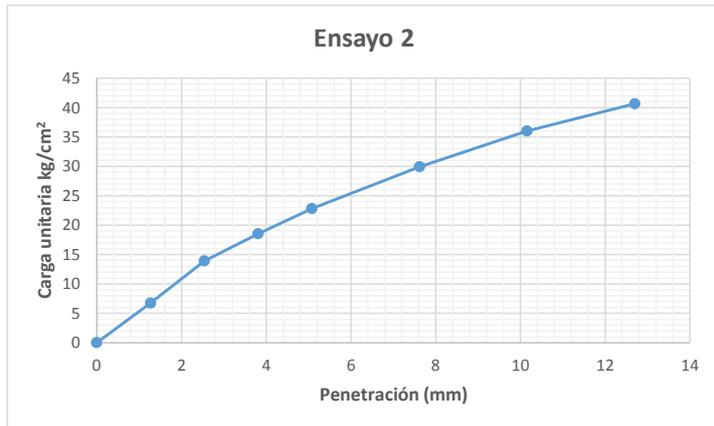
**Figura 3.16** Curva carga unitaria vs. penetración del ensayo 2.
