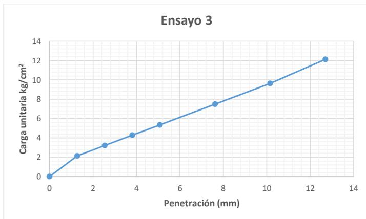
**Figura 3.17** Curva carga unitaria vs. penetración del ensayo 3.
