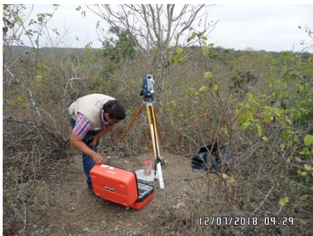
**Figura 2.6** Medición de coordenadas de puntos de control con estación total en zona de estudio.
