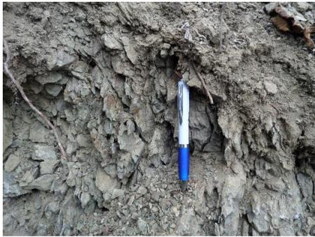
**Figura 1.5** Afloramiento de lutitas y chert alterado
