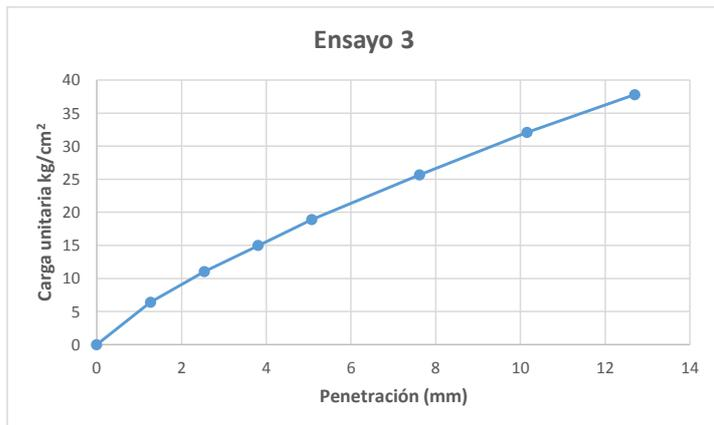
**Figura 3.21** Curva carga unitaria vs. penetración del ensayo 3.
