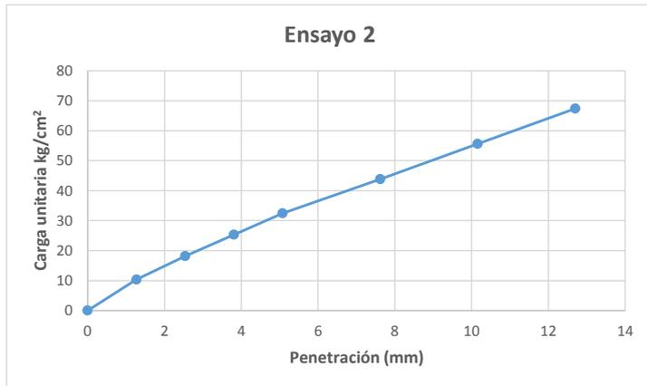
**Figura 3.20** Curva carga unitaria vs. penetración del ensayo 2.
