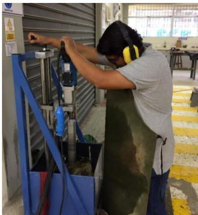
**Figura 2.14** Extracción de núcleo de roca con taladro.
