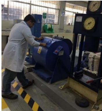
**Figura 2.19** Realización del ensayo de abrasión de los Ángeles
