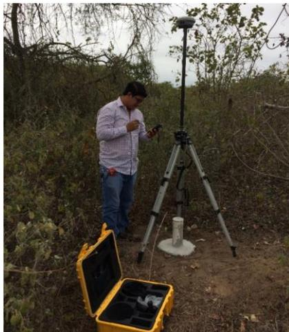
**Figura 2.5** Toma de coordenadas arrastradas de hito del IGM a la zona de estudio con GPS diferencial.
