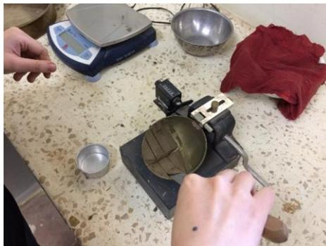
Figura 2.18 Determinación del límite líquido con Copa de Casagrande.
