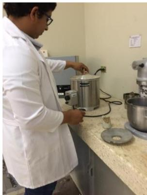
**Figura 2.13** Ensayo para determinar la densidad con parafina.
