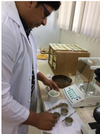
**Figura 2.12** Determinación del porcentaje de carbonatos en el laboratorio de petrografía
