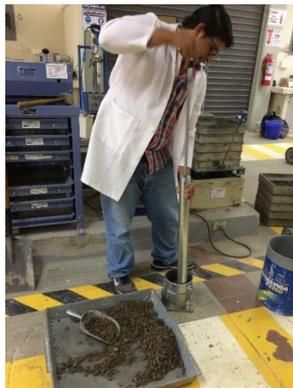
**Figura 2.20** Compactación de material en la realización del ensayo Proctor.
