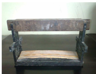
Figura 21 Dispositivo de sujeción y láminas de madera
