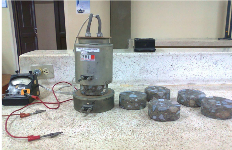
Figura 24 Ensayo para determinar la conductividad térmica del HCR marca CENCO
