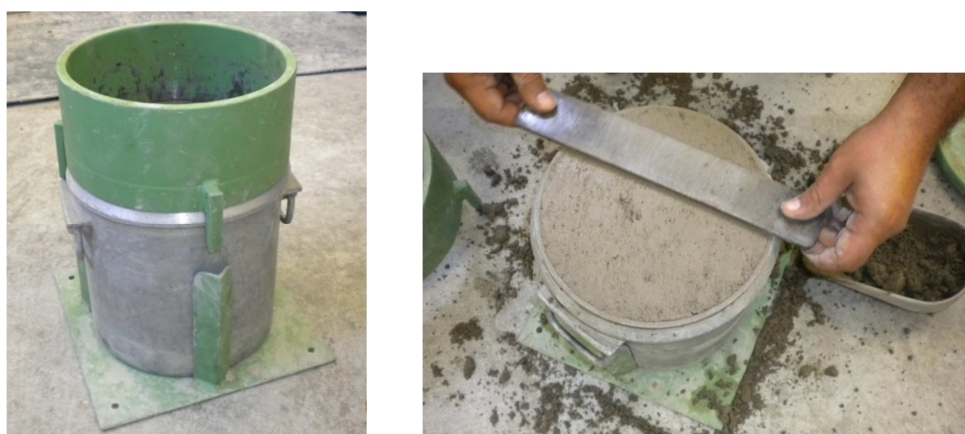
Figura 4 Ensayo para determinar la densidad
