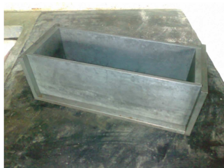
Figura 25 Vigueta metálica de dimensiones 102 x 102 x 286 mm
