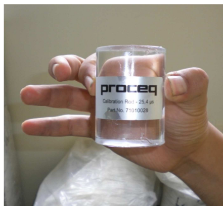
Figura 27 Barra de Calibración del Equipo de pulso ultrasónico
