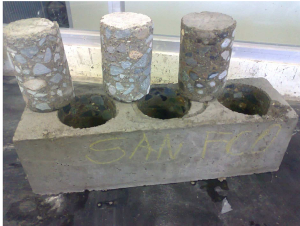
Figura 23 Extracción de núcleos
