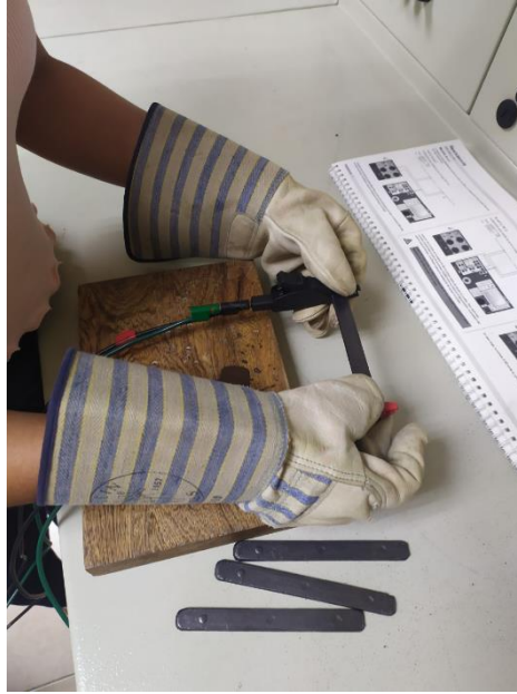
Ilustración D.5 Mediciones de conductividad eléctrica en el laboratorio de potencia FIEC
