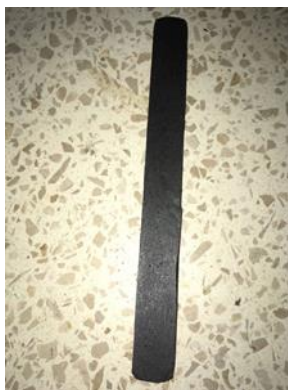
Ilustración 2.5 Probeta utilizada para la prueba de flexión
