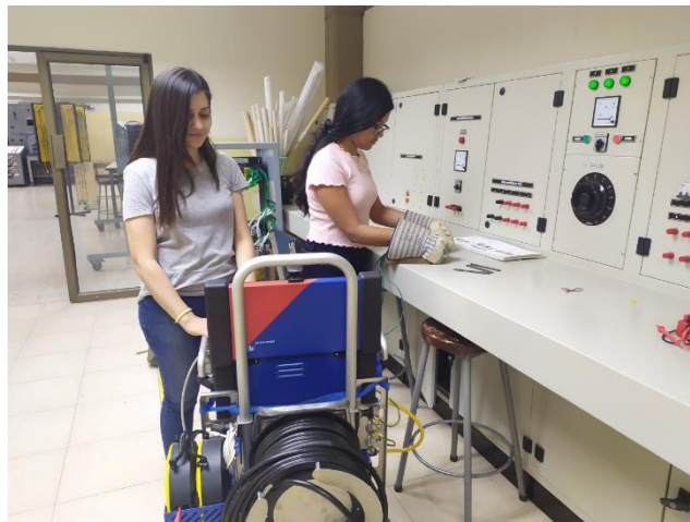
Ilustración D.4 Medición de conductividad eléctrica en el laboratorio de potencia FIEC
