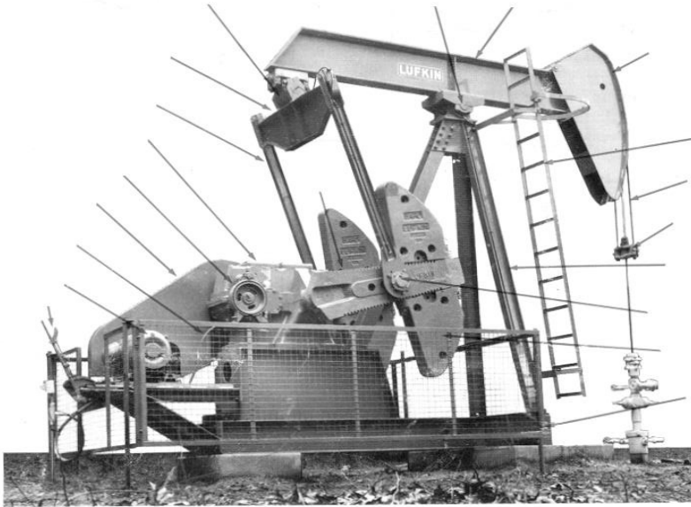
Figura1.20 Unidad de Bombeo Mecánico Convencional
