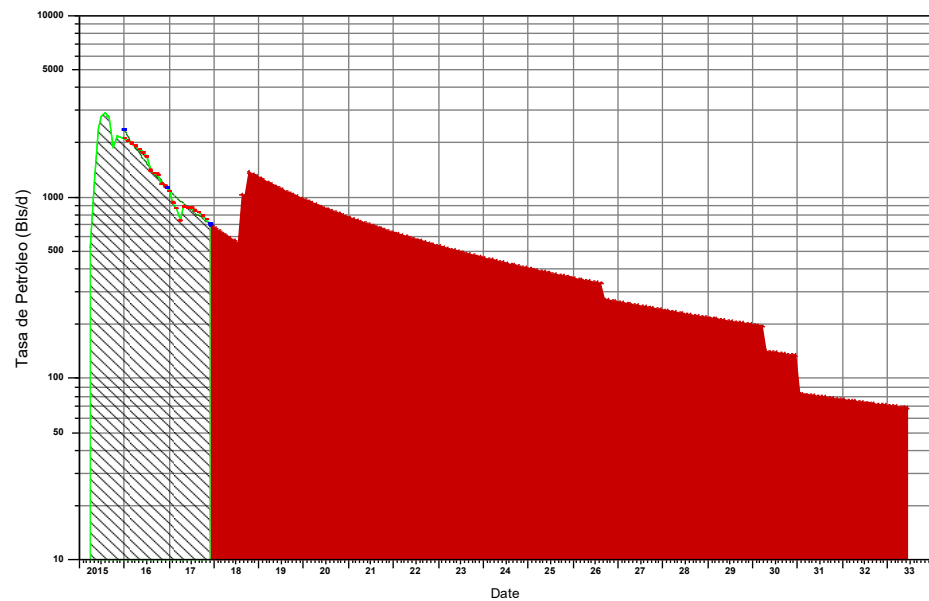
Figura 3.18 Simulación del histórico de producción y pedicción del comportamiento futuro del reservorio Basal (Chiang & Eras, 2019)
