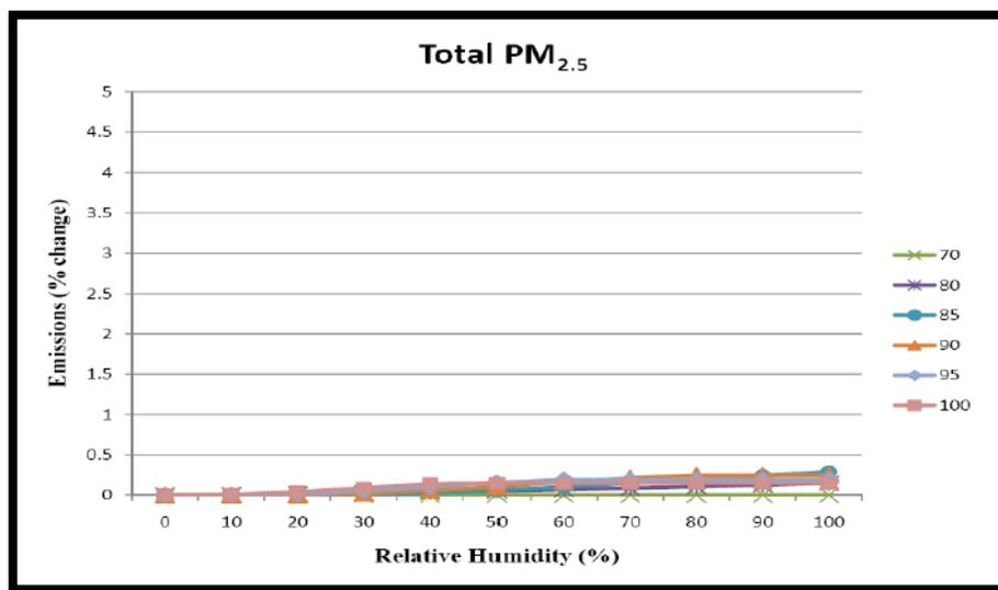
**Figura 5. Relación de cambio de emisiones con respecto al cambio de humedad relativa, con diferentes valores de temperatura 70,80,85,90,95,100 grados Fahrenheit.n(Fuente: MOVES Workshop, 2011)**
