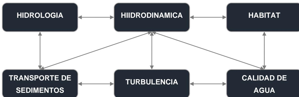
Figura 2.8 Módulos del Softwar Iber 2.5
