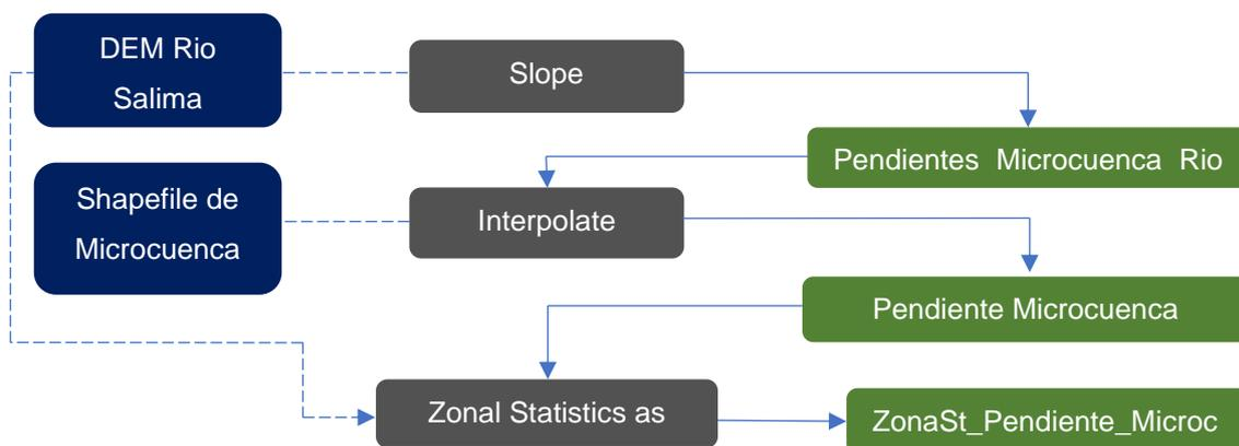
**Figura 2.6 Proceso para determinar la pendiente media de una Cuenca.**
