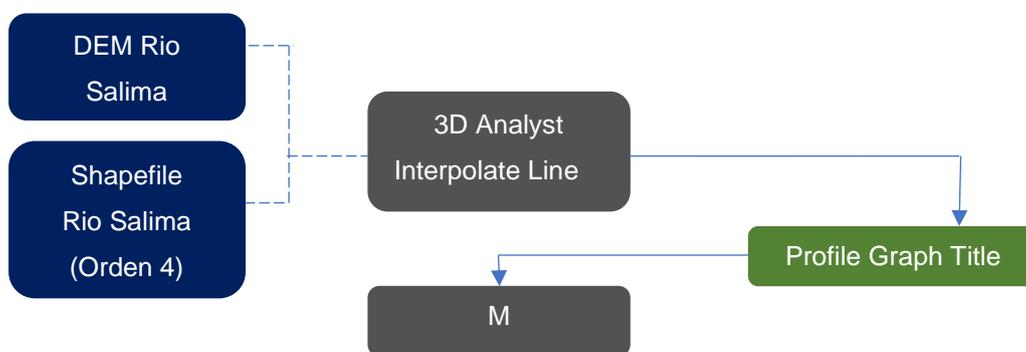
Figura 2.7 Proceso para determinar Perfil Longitudinal del Rio Salima
