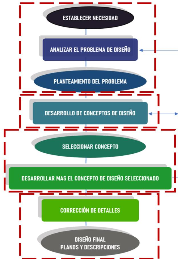
Figura 2.1 Proceso de Diseño de French.
