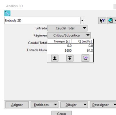
Figura 2.11 Registro de condiciones de contorno en la entrada y salida del rio.
