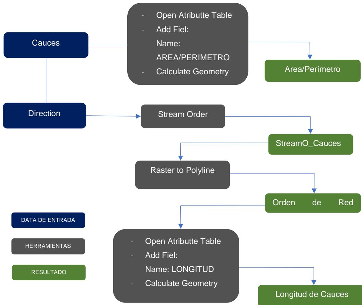
**Figura 2.5 Proceso para determinar características generales de una Cuenca**
