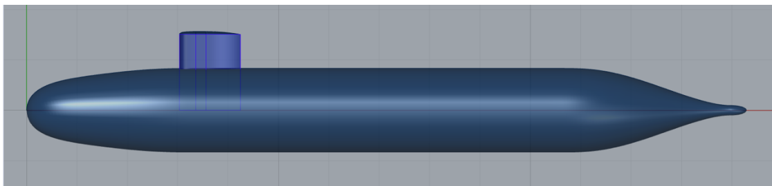
Ilustración 113. Geometría tipo Superficie del model DARPA SUBOFF en Rhinoceros
