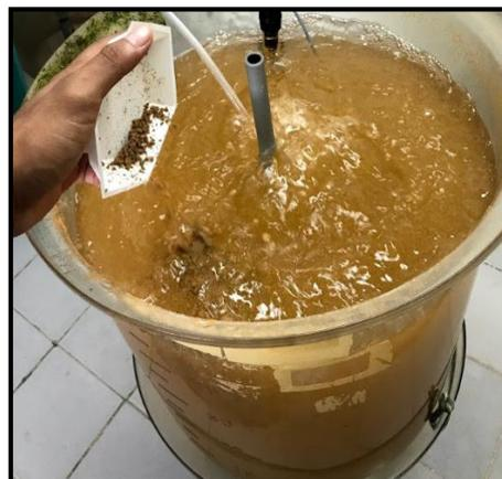
**Gráfico 3.3 Tanque despues de la decapsulación para suministrar 10 ppm de Eo de orégano.**
