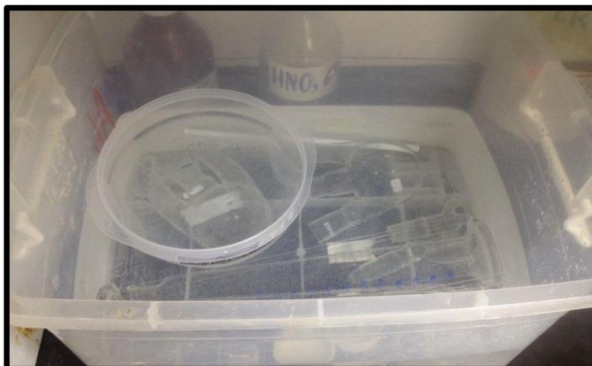
**Figura 2.6 Vidriería remojando en solución de HNO<sub>3</sub> (10%)**
