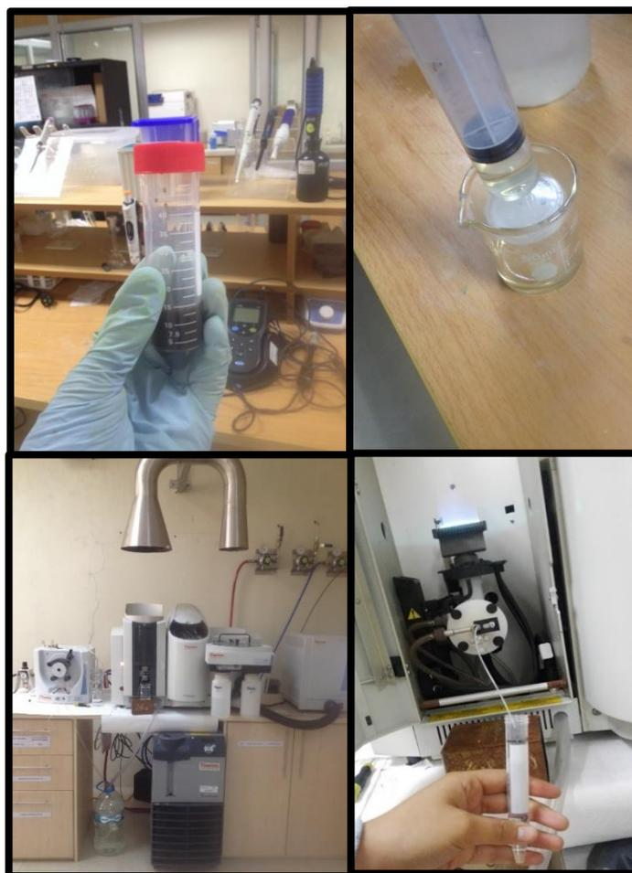
**Figura 2.8 Filtración del extracto y determinación de metales en EAA**
