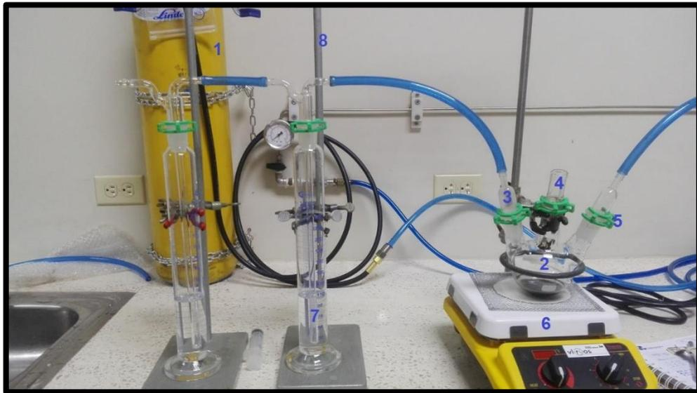
**Figura 2.1 Sistema utilizado para la obtención de AVS**
