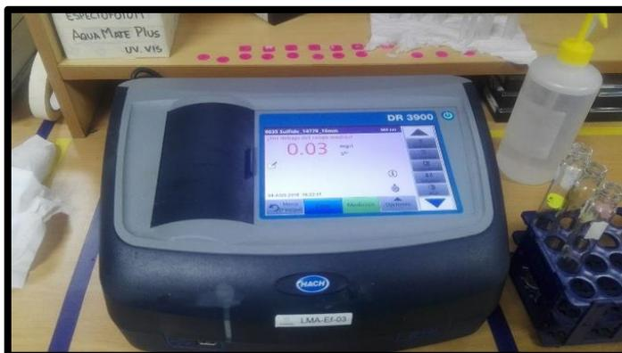
**Figura 2.7 Espectrofotómetro utilizado para determinación de sulfuros**
