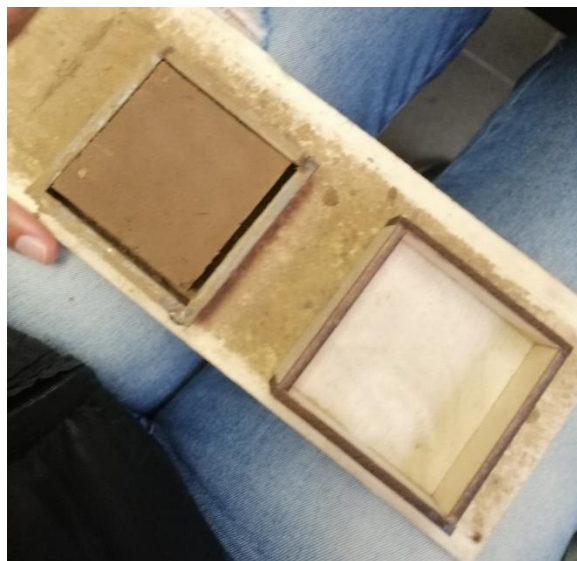
Figura 2.9 Muestra de cementante post secado al ambiente y molde utilizado
