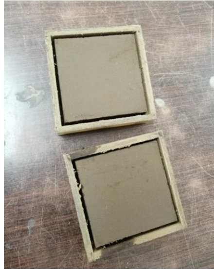
Figura 2.10 Muestras de cementante después de secado al ambiente
