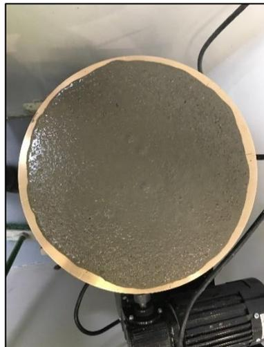
**Figura 2.36 Flujo Final Mortero de Cemento 2 (Autor)**
