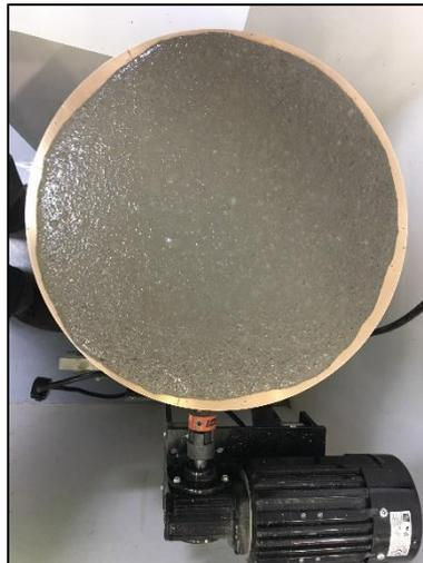
**Figura 2.38 Flujo Final Mortero de Cemento 4 (Autor)**
