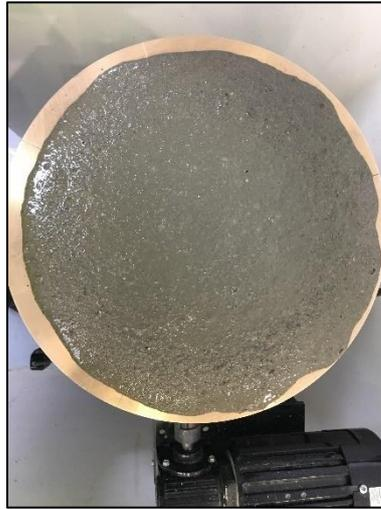
**Figura 2.37 Flujo Final Mortero de Cemento 3 (Autor)**
