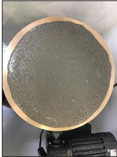
**Figura 2.39 Flujo Final Mortero de Cemento 5 (Autor)**
