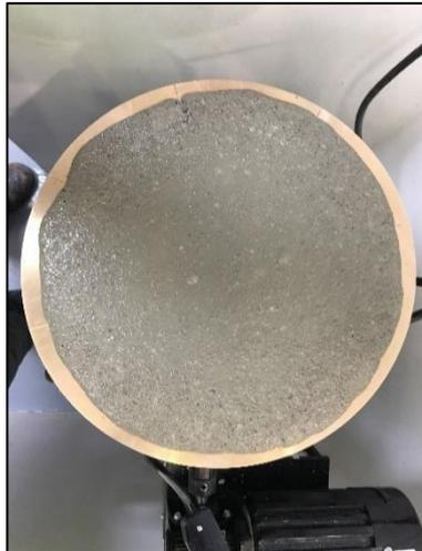
**Figura 2.35 Flujo Final Mortero de Cemento 1 (Autor)**
