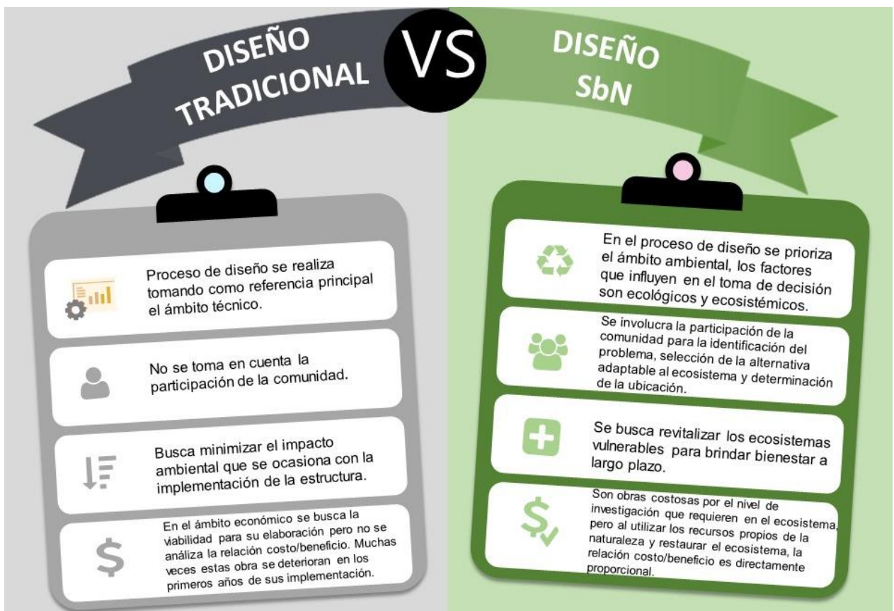
Ilustración 2.2. Gráfico comparativo entre una estructura gris y una solución basada en la naturaleza.
