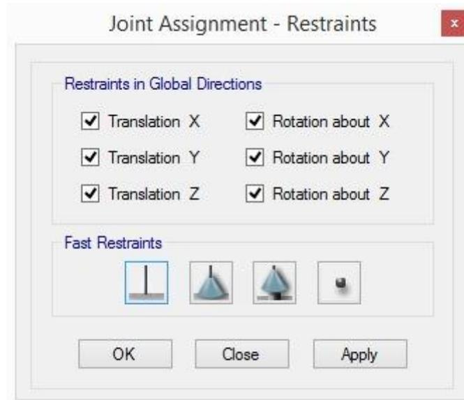
**Figura A-2 6 Definición de restricciones en los apoyos del modelo estructural [autores]**
