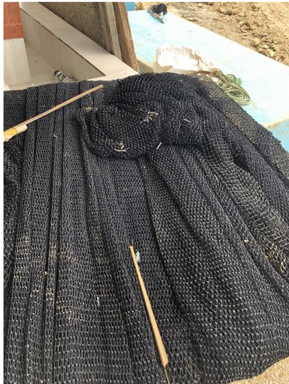
Fotografía 9 Malla de 7 mm para almohadas de 50X35. Fuente: Villao,2020.
