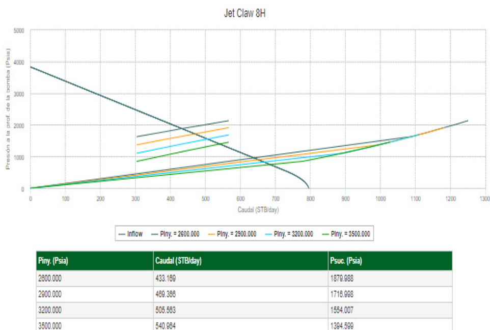
Figura 3.49 Proyección de la geometría 8H hasta una presión de inyección de 3500 psia- POZO ESPOL 03. Fuente: Software Syal©, Sertecpet.
