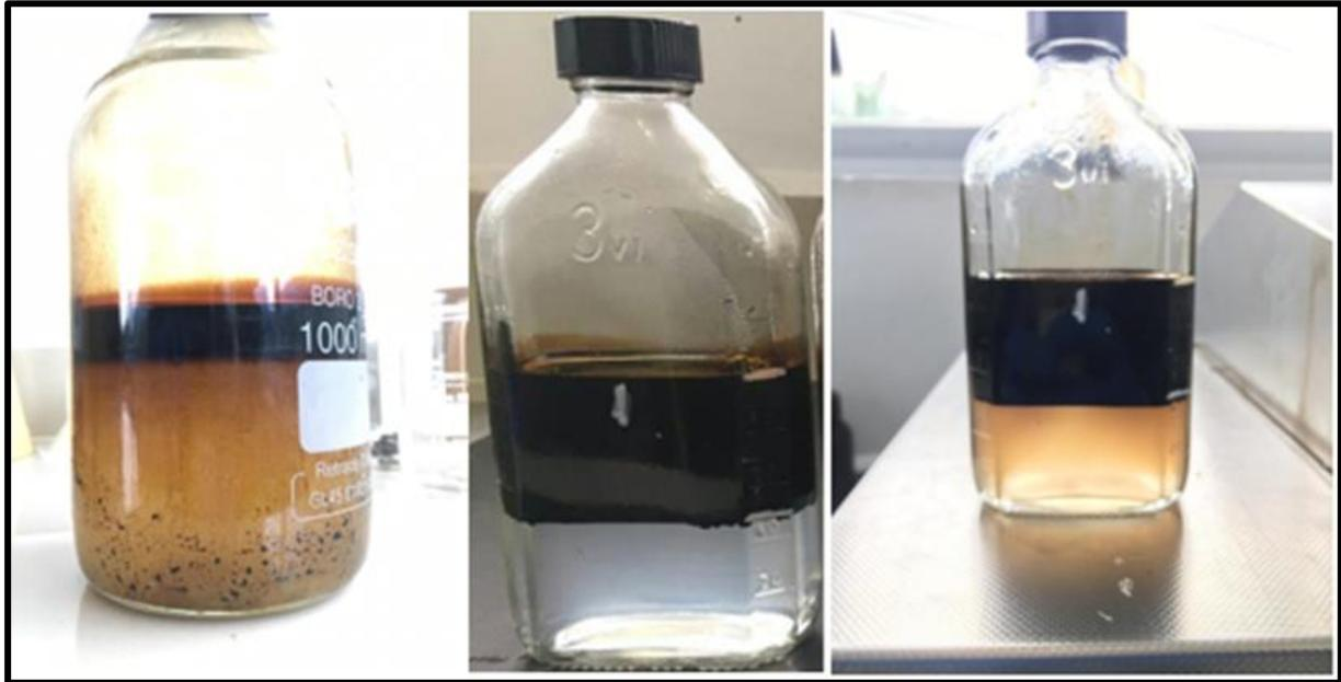
**Figura 3-2 Comparación del fluido de control convencional con los resultados de la prueba de emulsión a la muestra 1.**
