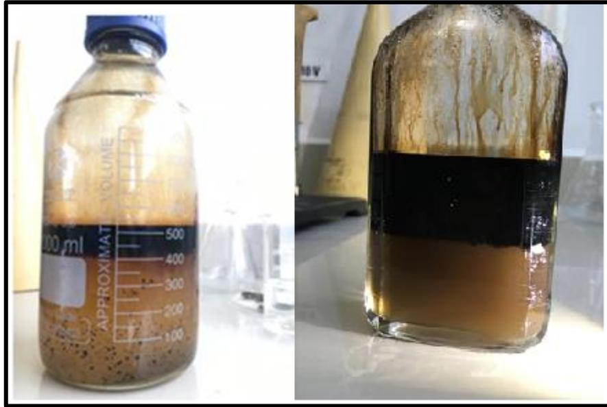
**Figura 3-6 Comparación del fluido de control convencional con los resultados de la prueba de emulsión de la muestra 2´.**
