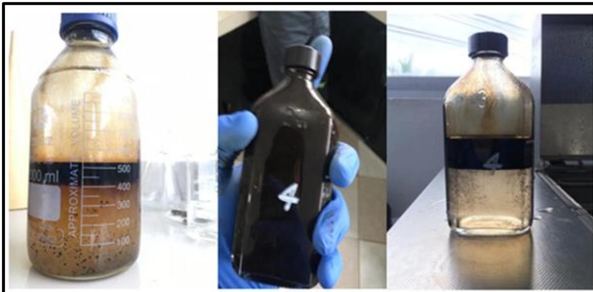
**Figura 3-4 Comparación del fluido de control convencional con los resultados de la prueba de emulsión a la muestra 4.**
