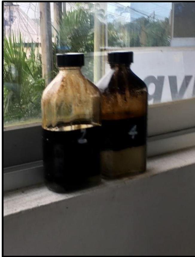
**Figura 3-5 Comparación de los resultados en la prueba de emulsión en la muestra 2 con los resultados de la prueba de emulsión de la muestra 4.**
