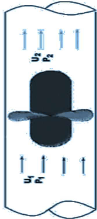
**Figura 2.10 Caída de presión de turbina Wells en un ducto**
