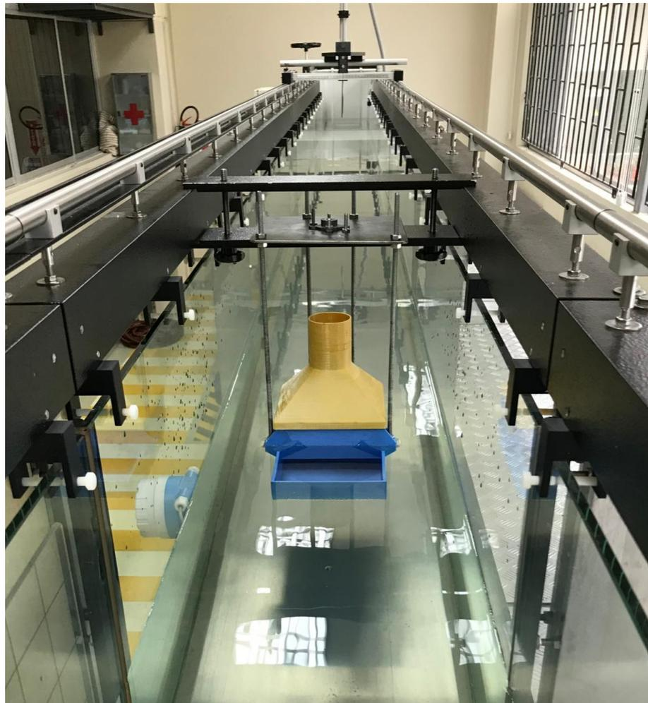
**Figura 3.7 Prototipo undimotriz en el banco generador de olas**
