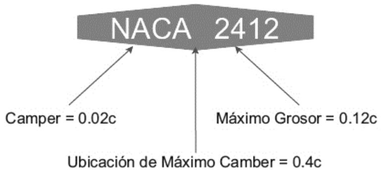
**Figura 2.11 Nomenclatura de un perfil NACA**
