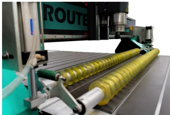
Figura 1.6 Método de sujeción con rodillos en el router CNC. [Fuente: STANSER]
