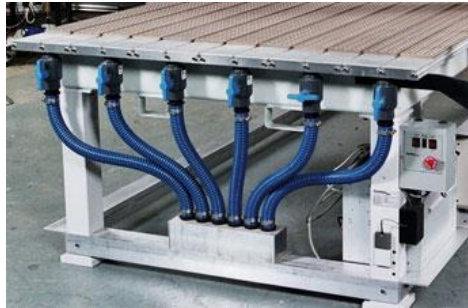
Figura 1.5 Método de sujeción por vacío en la cama del router CNC. [Fuente: cnccookbook.com]
