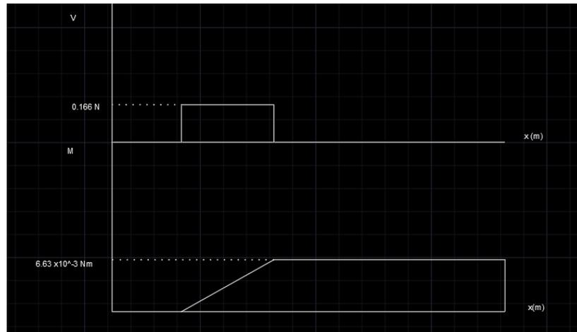
Figura 2.24 Diagramas de cortante y momento flector (Autores, 2020).
