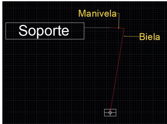
Figura 2.7 Mecanismo Biela – Manivela. (Autores, 2020)
