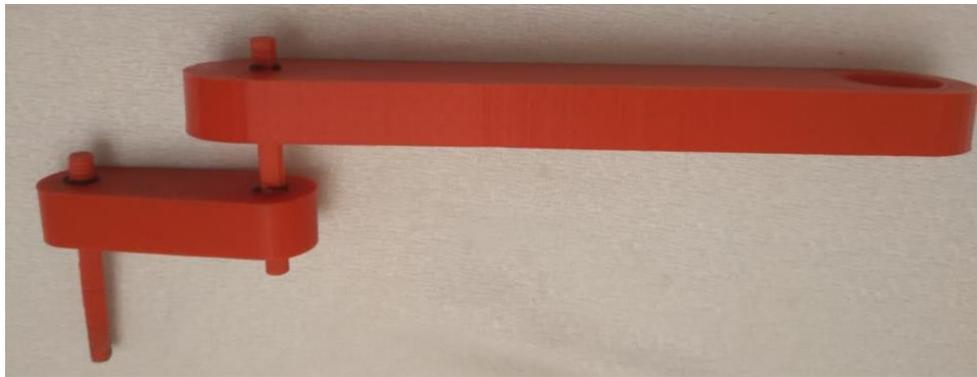
**Figura 3.4 Sistema de Biela y Manivela (Autores, 2021).**
