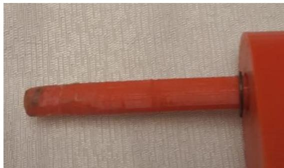
**Figura 3.9 Eje horizontal afectado por el maquinado (Autores, 2021).**
