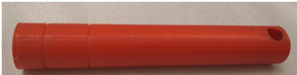
Figura 3.2 Brazo de conexión entre boya y la biela (Autores, 2021).
