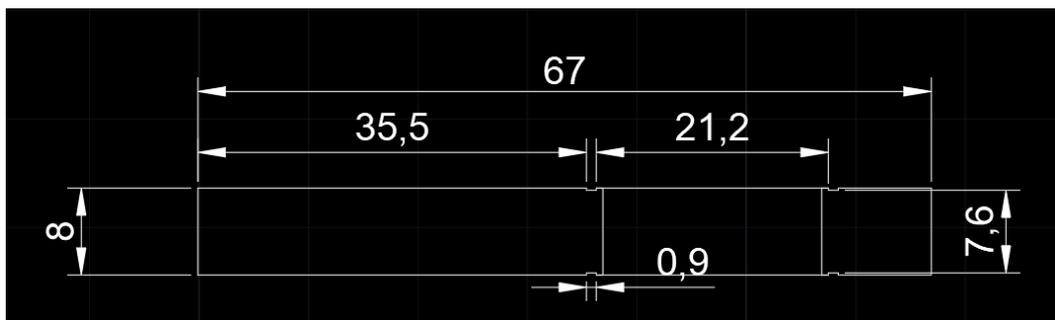
Figura 2.35 Esquema del eje (Autores, 2020).
