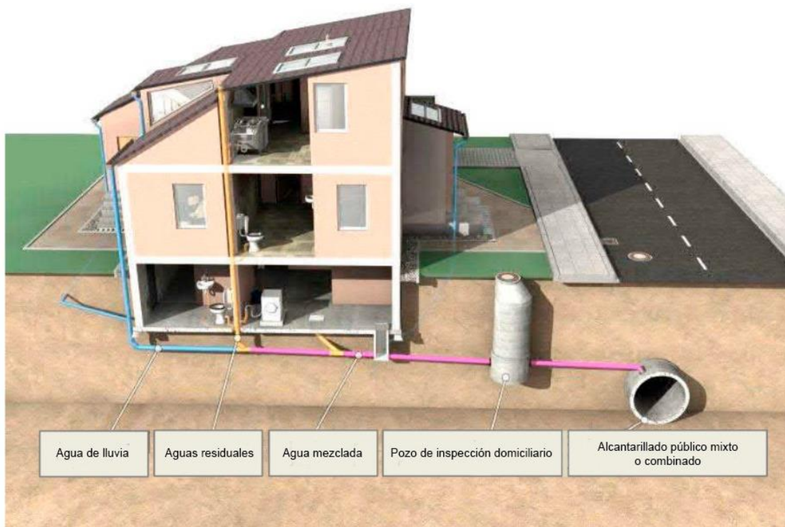
Conexión domiciliaria con derivación a alcantarillado mixto
