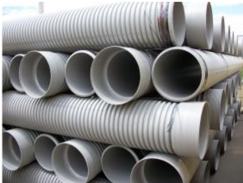
Figura 3-4 Almacenamiento de tuberías de PVC (Durman, 2013).
