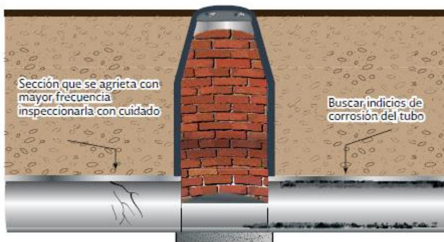
Figura 3-33 Estado típico de los colectores de alcantarillado MAPAS
