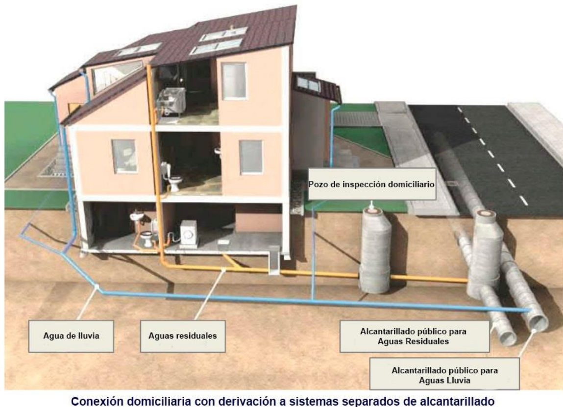
Figura 1-2 Sistema separativo de alcantarillado (Fumanelli, 2016)
