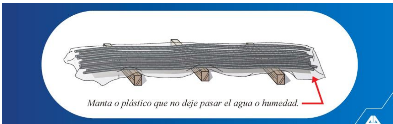
Figura 3-3 Almacenamiento del acero ( ACEROS AREQUIPA, 2018 )
