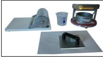
Figura 2.14 Accesorios para ensayo de COBB [MECALUX (2021) “Medidor de absorción de agua en cartón o papel”]
