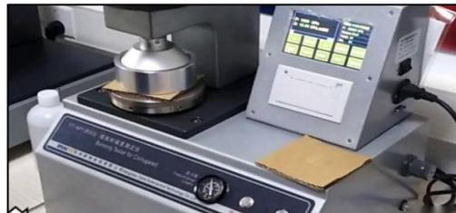
Figura 2.17 Prueba de Estallido. [YANTE (2021) "Equipo de prueba de ruptura"]
