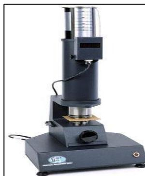
Figura 2.13 Ensayo de porosidad Gurley [Direct Industry (2021) “Densímetro para la determinación de la porosidad del papel”]
