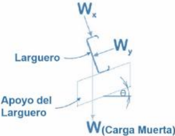
Figura 6.17 Carga en cada eje actuando en los largueros, Wx y Wy. (Barzola Navarrete & Carriel Contreras, 2020)
