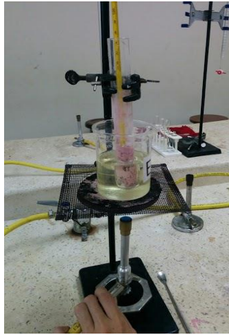
Imagen 5. Sistema de calentamiento con baño de glicerina.
