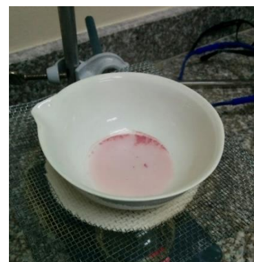
Imagen 5. Ensayo de solubilidad en agua para la crema importada.
