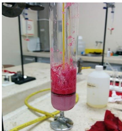
Imagen 6. Muestra en estado líquido. Se aprecian las fases formadas.
