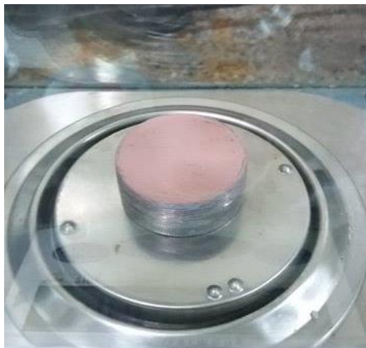
Imagen 4. Picnómetro con muestra de crema.
