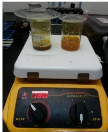
Figura 2. Calentamiento en Agua Regia de los Sedimentos de los ríos Daule y Babahoyo
