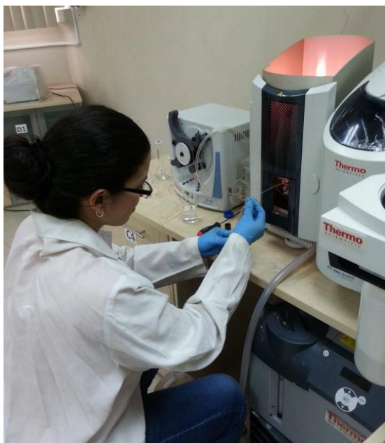
FIGURA 4.3.2. Registro del Blanco y estándares respectivos para formación de la Curva de Calibración del Metal a analizar
