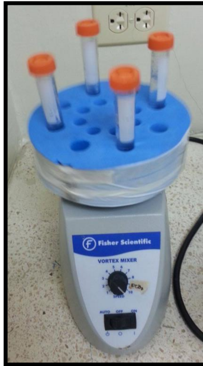
FIGURA 4.1.1.1. Agitación de las muestras de la Etapa 1 con Nitrato de Potasio (1M)
