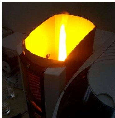
Figura 2. Color de la llama para una muestra de la Etapa 3
