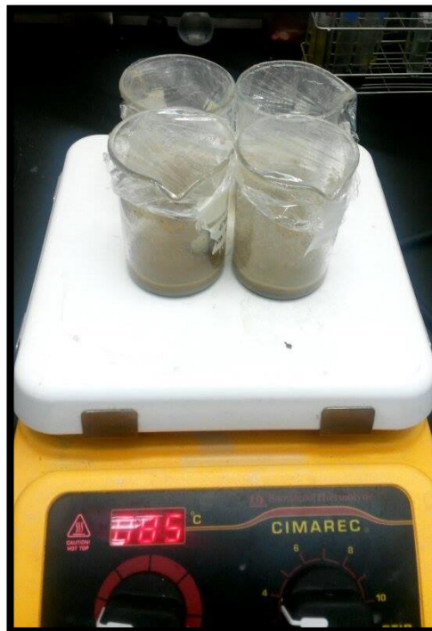
FIGURA 4.1.4.1. Calentamiento de las muestras en la Etapa 4 (Fase 1 y 2) a 85 °C.
