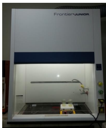
Figura 3. Sorbona para expulsión de los Gases producidos durante el Calentamiento con Agua Regia
