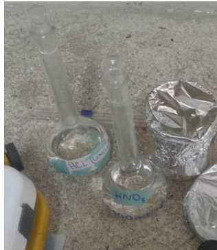
Figura 1. Agua Regia: Ácido Nítrico – Ácido Clorhídrico (1:3)
