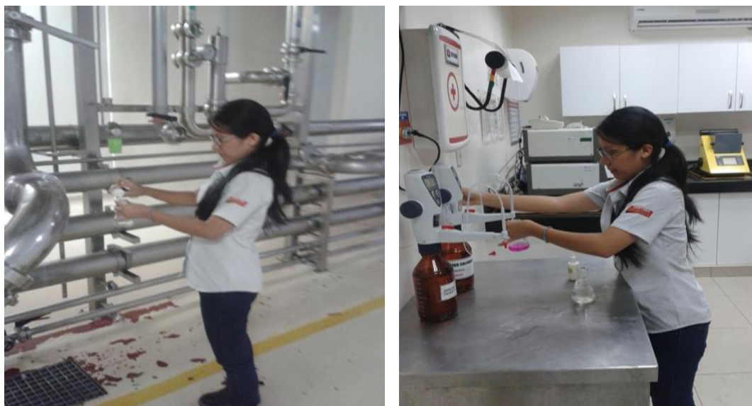
Figura 5.3-1. Verificación de ausencia de reactivos
