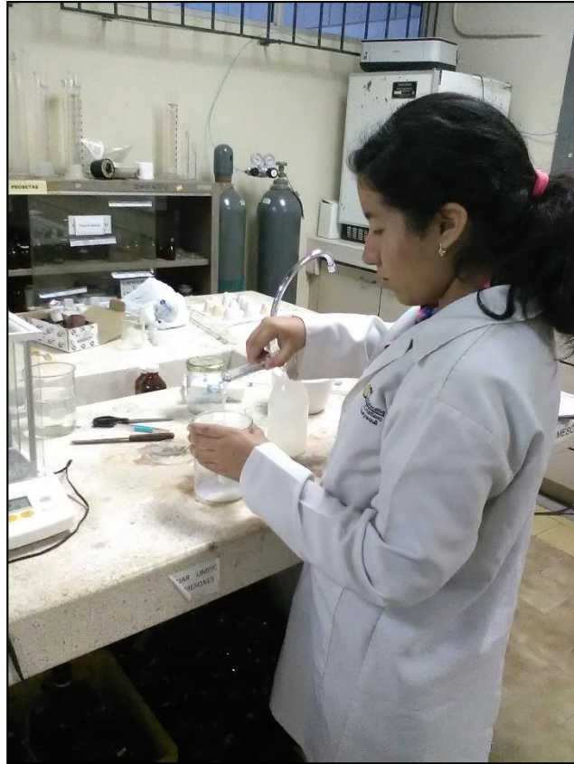
Preparación de la solución de sulfato de aluminio para dosificar como coagulante en el proceso.
