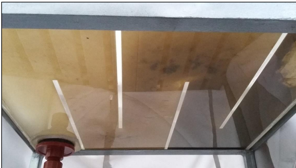
Vista inferior de las cámaras del tanque floculador en donde se observa las diferencias en la base de cada una por formación y descenso de los flóculos.
