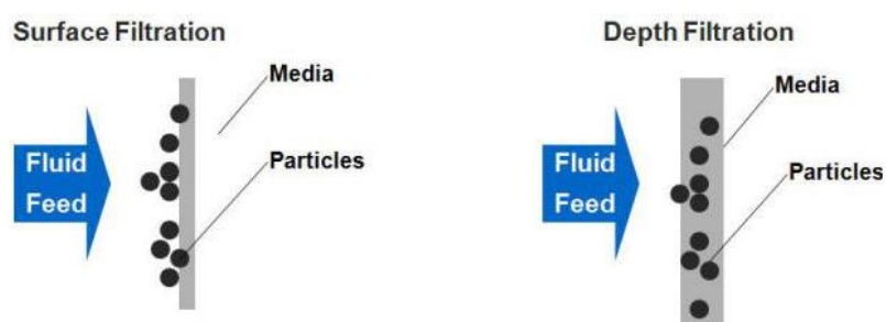
Figura 14. Filtros de superficie vs filtros de profundidad
