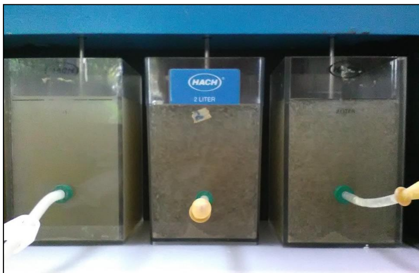
Test de jarras en la prueba 2 usando sulfato de aluminio y floculantes catiónicos y aniónicos.
