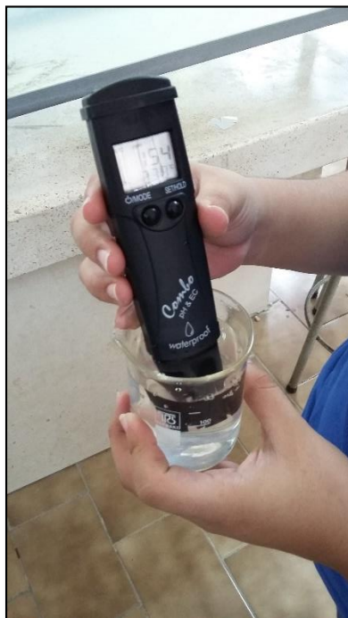
Lectura de STD, pH y conductividad en la muestra final de la prueba 3.
