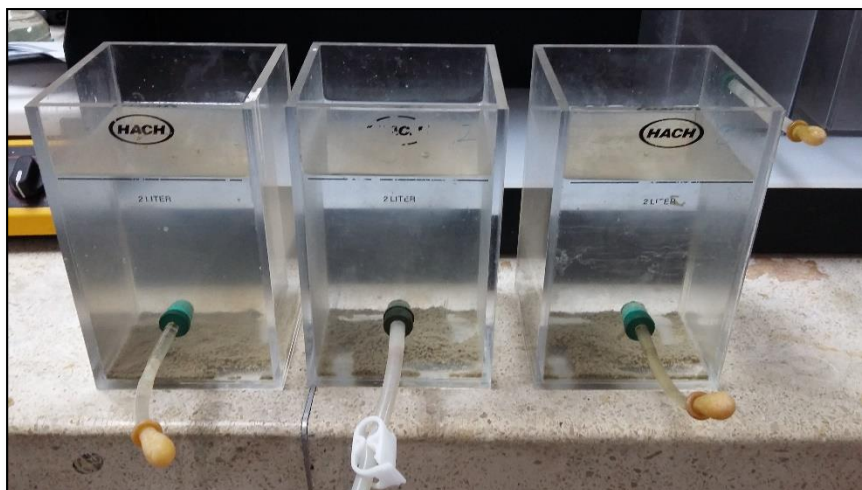
Resultado final de las tres jarras usadas en la prueba 3 del test de jarras donde se varió las concentraciones de sulfato de aluminio.
