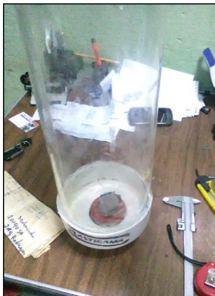
Imagen 5. Estructura del filtro: paredes de acrílico y base de PVC.
