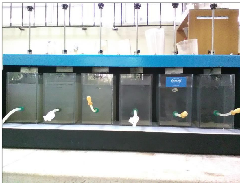
Resultado final del test de jarras de la prueba dos donde se observa un mejor rendimiento del sulfato de aluminio (jarras 4,5 y 6) versus el policloruro de aluminio (jarras 1,2 y 3)
