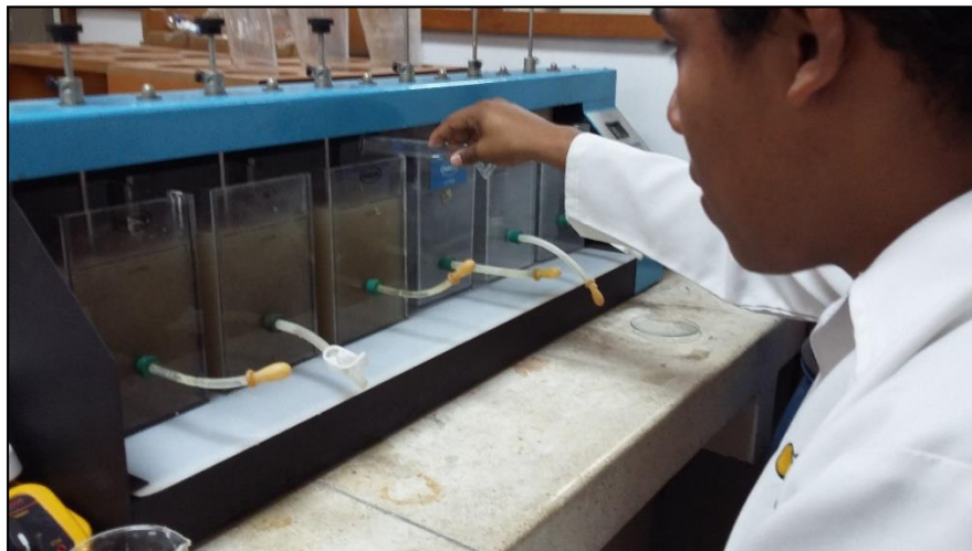
Adición de floculante en la prueba 3 para observar la diferencia entre las jarras.
