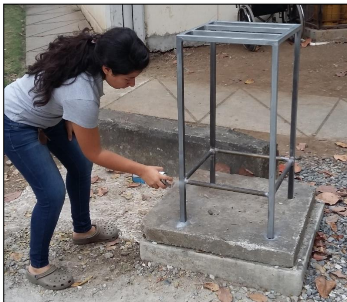
Imagen 4. Bases metálicas para las unidades. Recubrimiento del material con pintura en spray.
