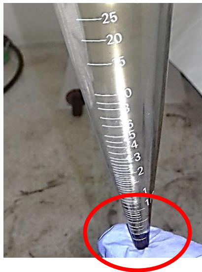
Imagen 9. Muestra centrifugada a 25 °C y 400 RPM
