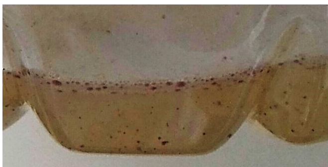
Imagen 11. Capa oleosa formada en la aireación
