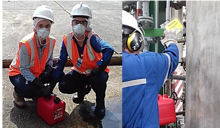
Imagen 5. Toma de muestra de la sosa gastada del proceso Merox-GLP
