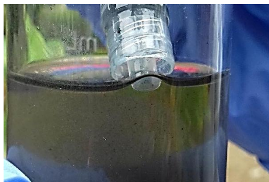
Imagen 7. Capa oleosa formada por mercáptidos, fenoles y disulfuros de sodio
