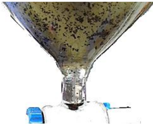
Imagen 8. Sedimentación natural de sulfuros de sodio en la muestra tratada a 25 °C
