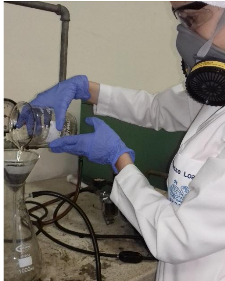
Imagen 10. Proceso de Filtración al Vacío
