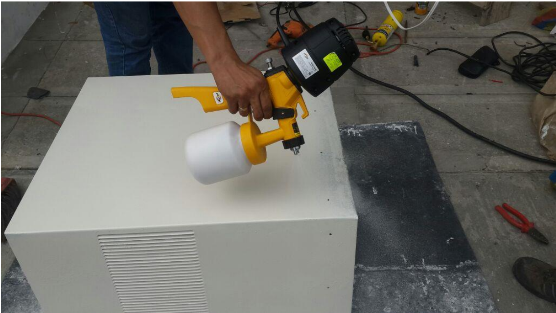
Ilustración 56.- Pintando la carcasa del equipo
