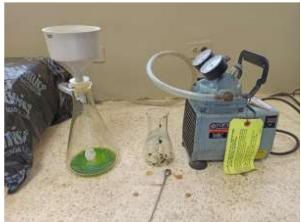
Figura B.4 Filtración al vacío de extractos
