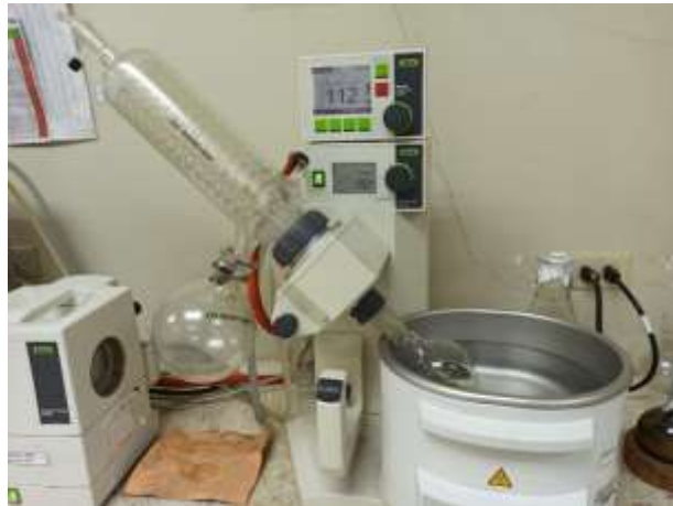
Figura B.6 Rotaevaporación de extractos
