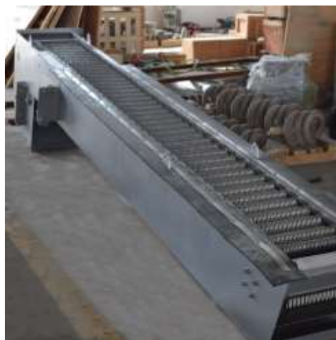
Figura 2.5 Filtro de rejillas transportadores. [Alibaba, 2021]
