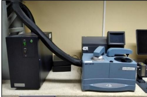
**Figura 2.5 Calorímetro TA Instruments.**
