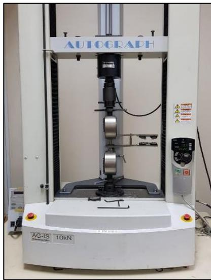
**Figura 2.7 Equipo para ensayo de tensión.**
