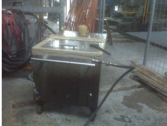
FIG. 7.3 – TANQUE DE CONDENSACIÓN DE LAS PURGAS
