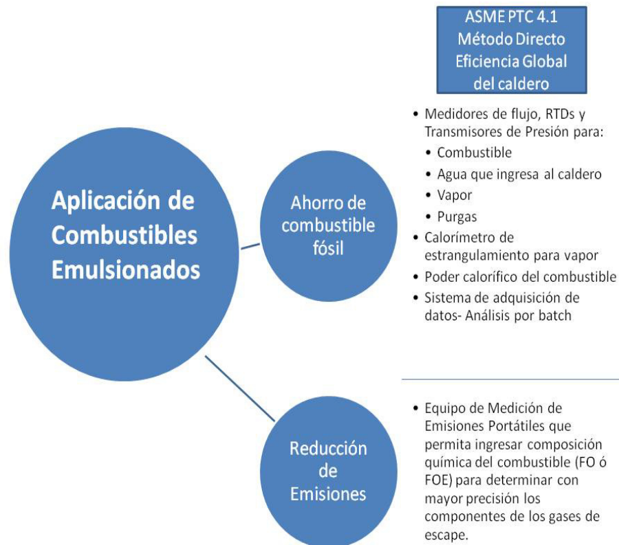
FIG. 3.2- ESQUEMA DE EQUIPOS REQUERIDOS PARA LA MEDICIÓN DE PARAMETROS EN LA FASE PILOTO
