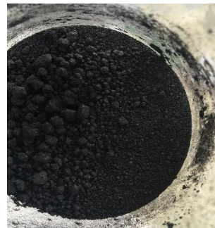
Ilustración 2.5 Polvo resultante de la evaporación de acetona
