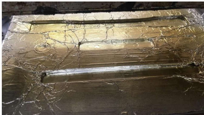
Ilustración 2.2. Preparación del molde previo a la elaboración de probetas
