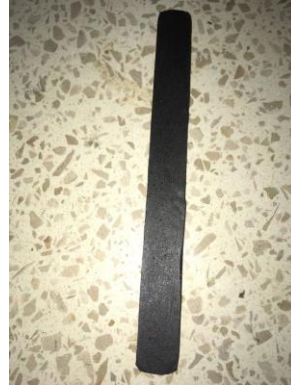
Ilustración 2.10 Tipo de probeta utilizada para prueba de flexión
