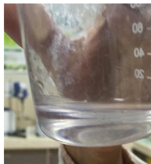
Ilustración 2.4 Mezcla homogénea de acetona y resina EPON – 828
