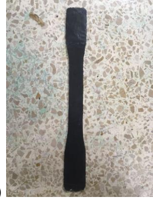
Ilustración 2.11 Equipo y tipo de probetas utilizadas en prueba de tensión
