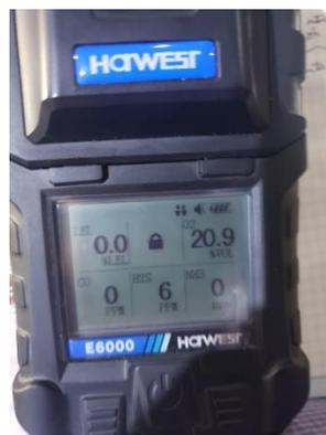
**Figura 3.6 Medición de gases en el área de reactor [Elaboración propia]**
