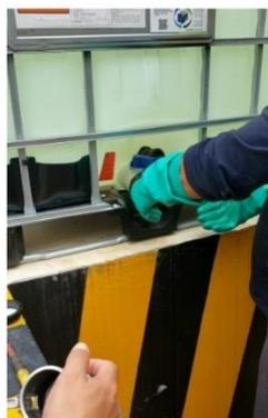
**Ilustración 4** Insertar el acople plástico negro a la boquilla
