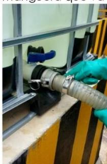
Ilustración 11 Retirar el extremo de la manguera que va a la boquilla del tanque IBC
