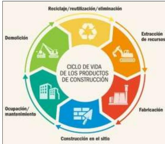
Figura 5.1 Diagrama del ciclo de vida de productos de construcción [Arteta R., 2017]
