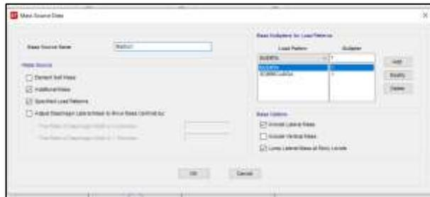
**Figura 3.13 Definición de peso sísmico**
