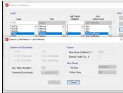
**Figura 3.15 Definición de carga sísmica estática**
