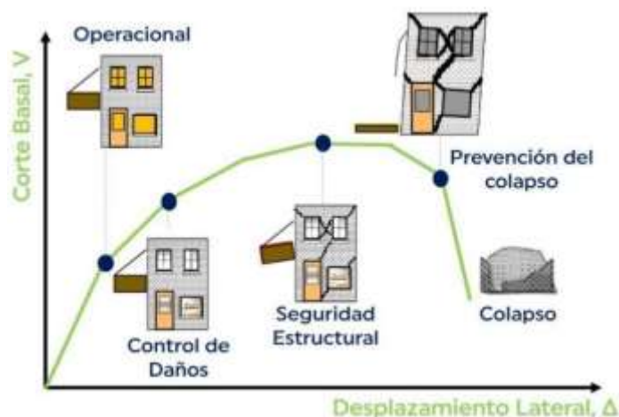
Figura 2.2 Daños relacionados con los parámetros de demanda sísmica. [ Fuente: SEAOC 1995]
