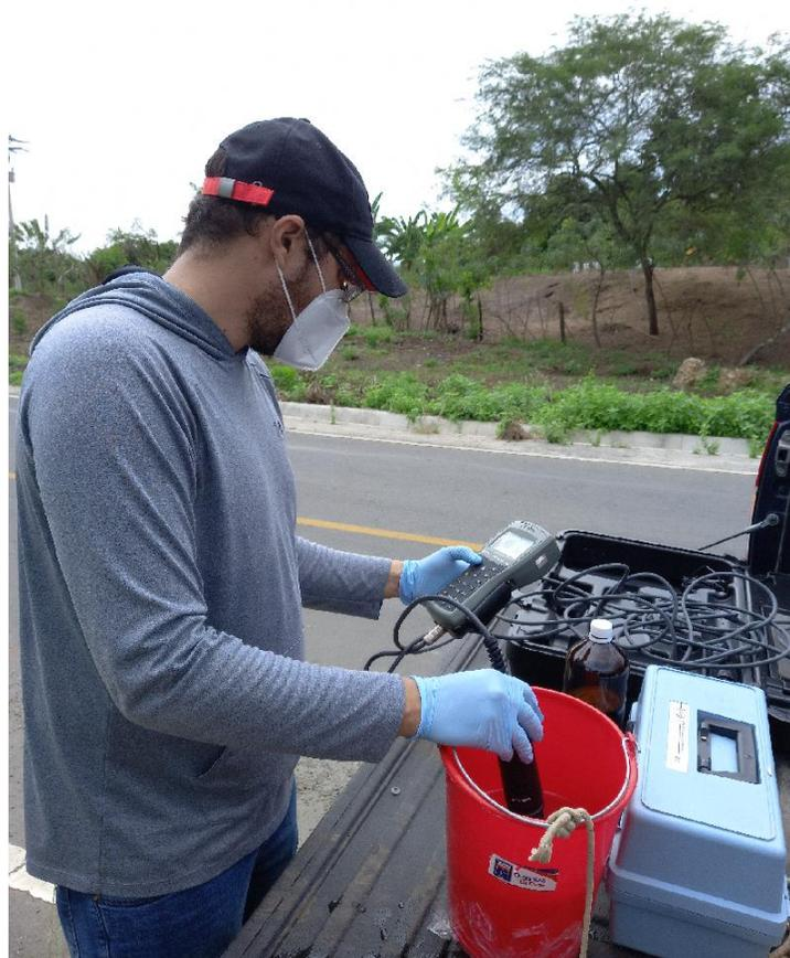
**Imagen 2.3 Medición de parámetros in-situ con el medidor multiparamétrico y turbidímetro. Fuente: El autor**
