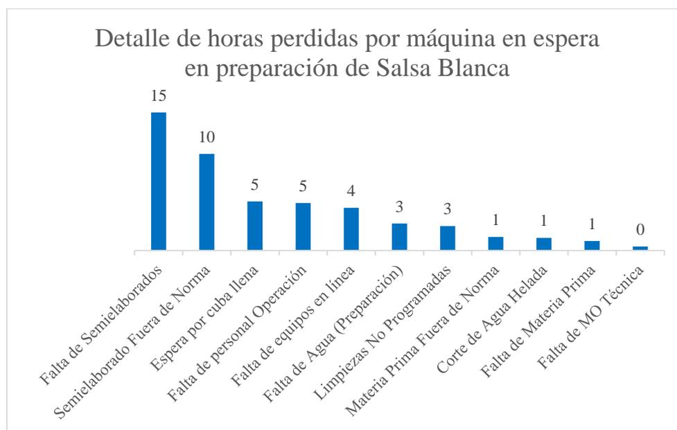
**Figura 35. Horas perdidas por máquina en espera en la preparación de Salsa Blanca**
