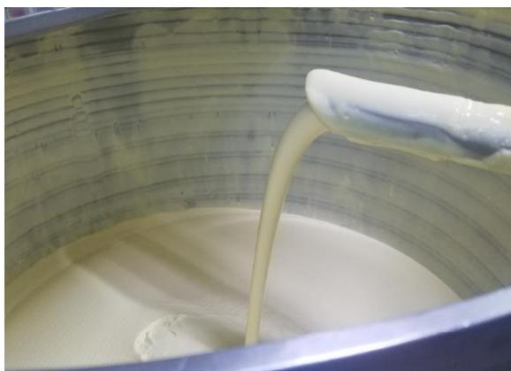
**Figura 49. Descarga actual de Salsa Blanca en tanque pulmón**
