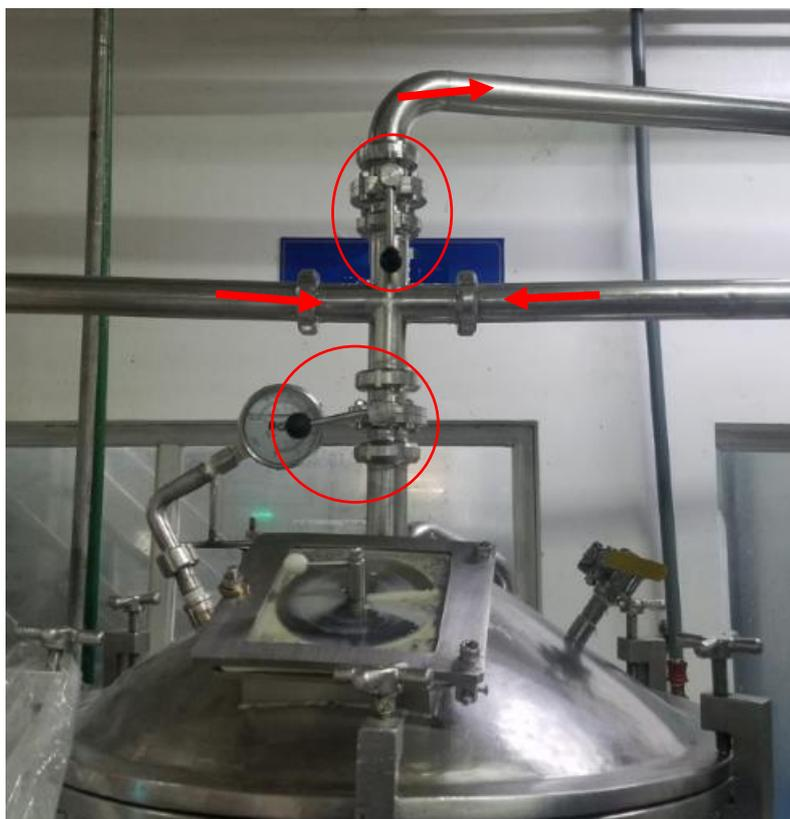
**Figura 48. Juego de válvulas manuales para paso o recirculación de Salsa Blanca**
