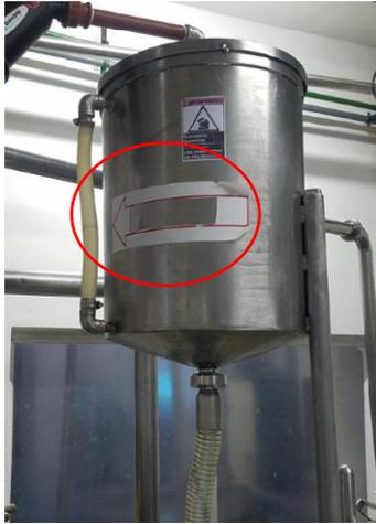
**Figura 66. Tanque de ácido acético con nivel de altura visual (flecha)**
