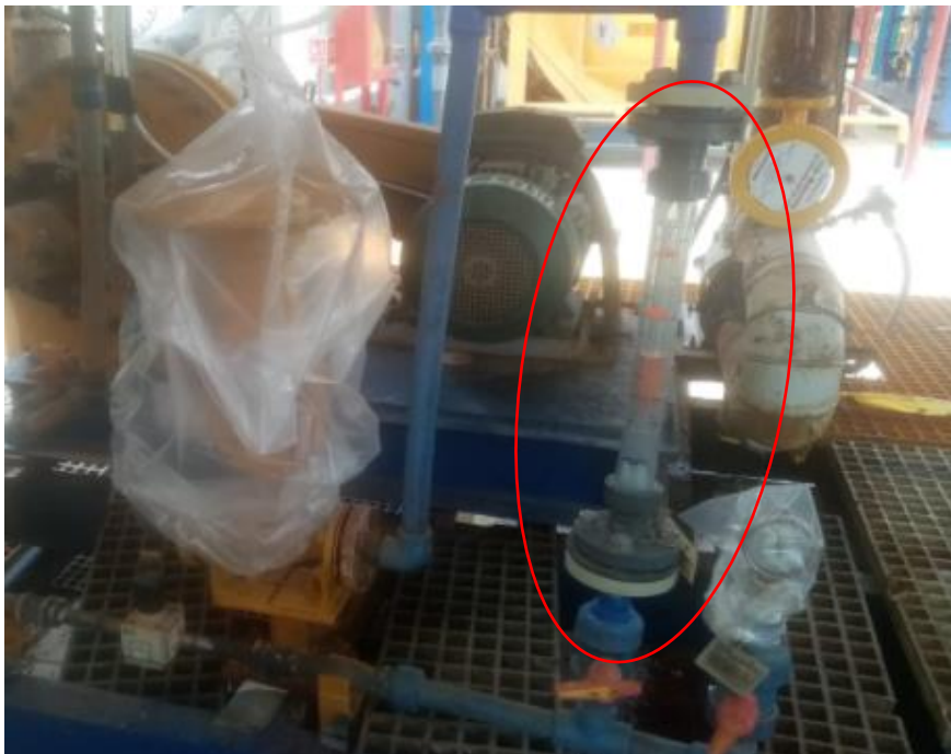
Figura 17. Cambio de rotámetro por uno de mayor flujo
