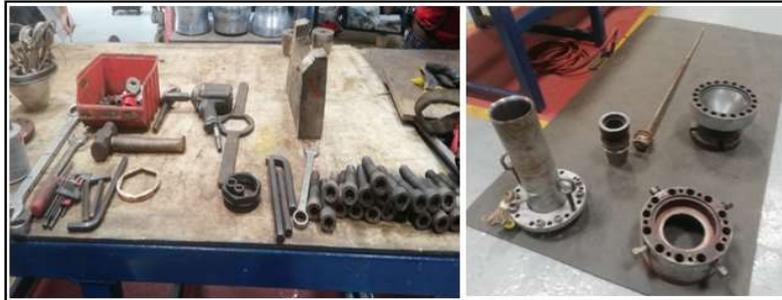
**FIGURA 2.11 HERRAMIENTAS Y COMPONENTES DEL MOLDE**
