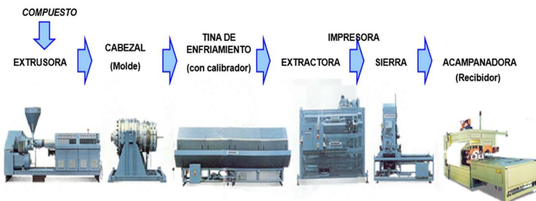
**FIGURA 1.4 ESQUEMA DE UNA LÍNEA DE PRODUCCIÓN DE TUBERÍA PLÁSTICA.**
