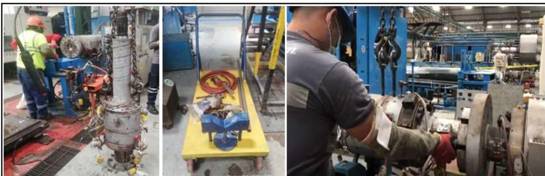
**FIGURA 2.22 MONTAJE DE MOLDE EN LA EXTRUSORA**
