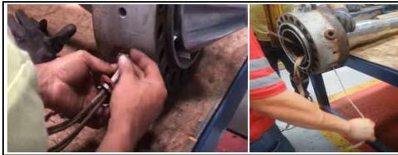
**FIGURA 2.14 PASAR CABLES POR ORIFICIOS DE ARAÑA DEL MOLDE**
