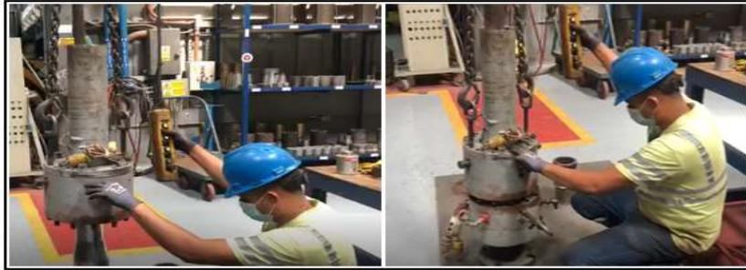
**FIGURA 2.20 ACOPLA DE HEMBRA INICIAL CON HEMBRA FINAL DEL MOLDE**
