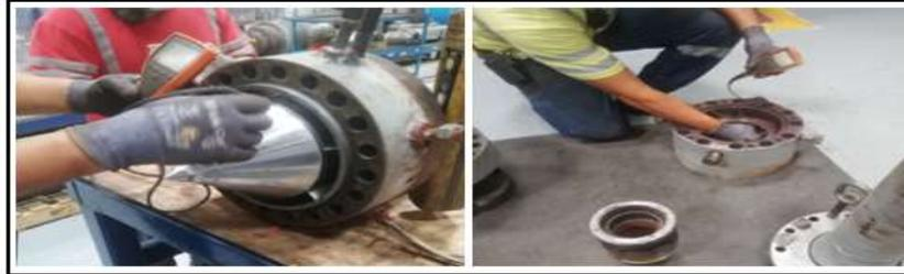
**FIGURA 2.17 INSPECCIÓN DEL MOLDE Y MEDICIÓN DE NIVEL DE CROMO**
