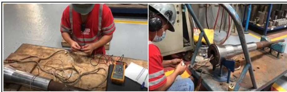
**FIGURA 2.12 CONEXIONES ELÉCTRICAS DE ZONAS DE CALENTAMIENTO**
