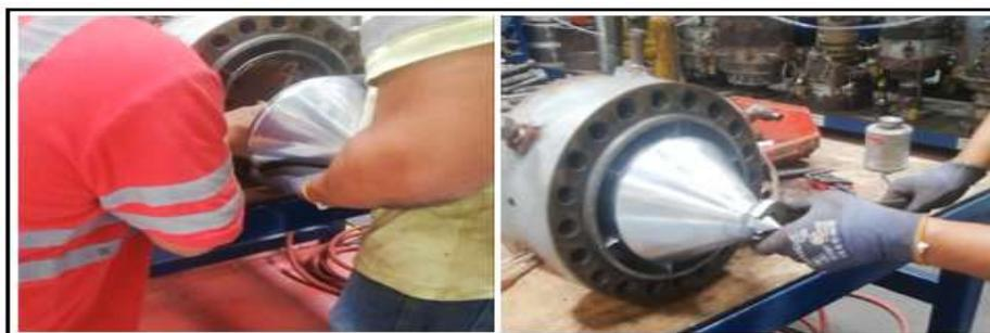
**FIGURA 2.16 ACOPLA DEL CONO CON TUERCA PUNTA DEL CONO**
