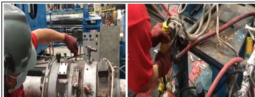
**FIGURA 2.7 DESCONEXIONES ELÉCTRICAS Y RETIRO DE FAJAS CALENTADORAS**
