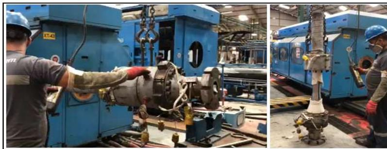
**FIGURA 2.9 DESMONTAJE Y LIMPIEZA DEL MOLDE**
