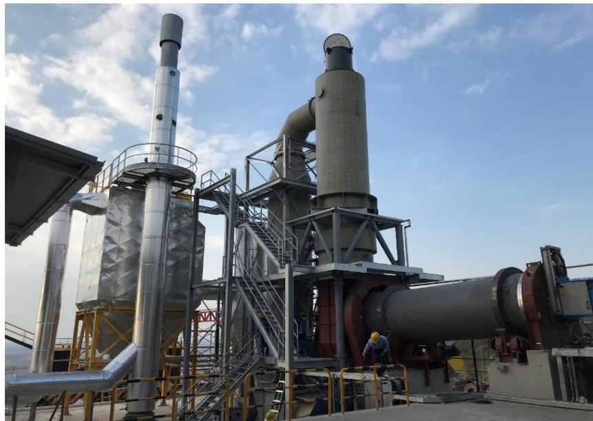
**Figura 1.21.** Horno rotatorio para incineración de desechos
