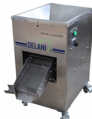
Gráfico 3 24 Especificaciones Separador de Grano (DELANI, 2018)
