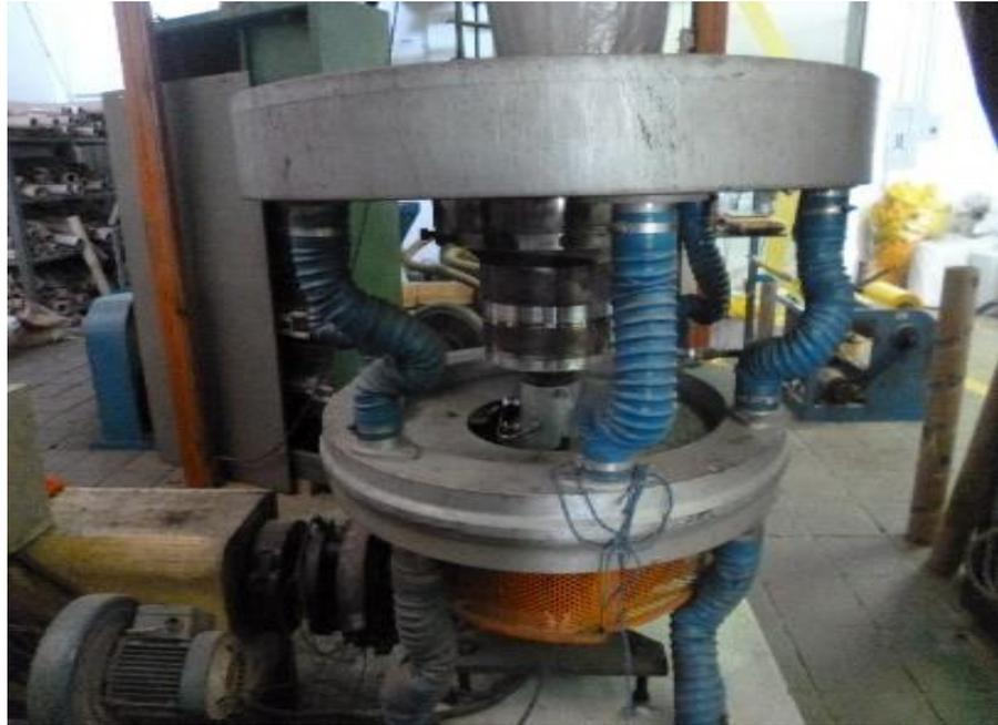
**FIGURA 2.10 CABEZAL DE MÁQUINA EXTRUSORA**
