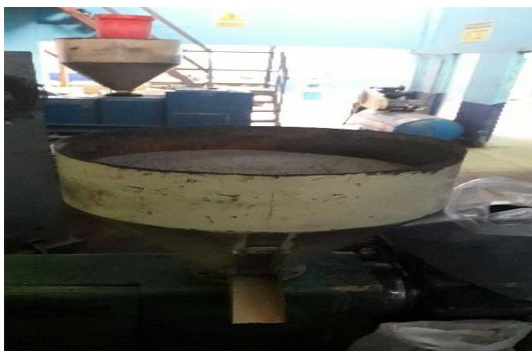
**FIGURA 2.8 TOLVA DE MÁQUINA EXTRUSORA**
