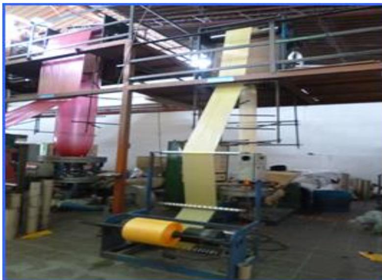
**FIGURA 2.7 MÁQUINA EXTRUSORA DE PELÍCULA SOPLADA**
