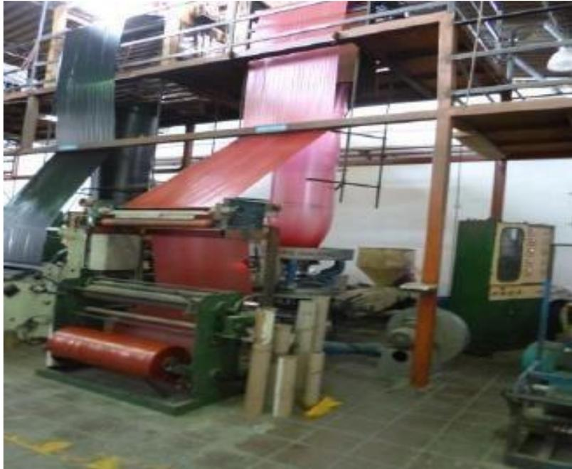
**FIGURA 2.13 BOBINADORA DE ROLLO DE MÁQUINA EXTRUSORA**
