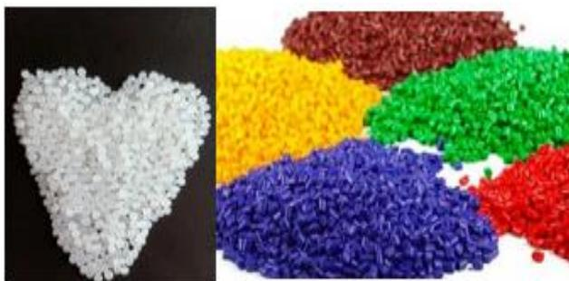
**FIGURA 2.5 PELETS DE POLIETILENO VIRGEN Y PELETIZADO**
