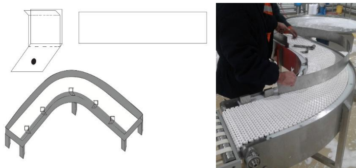
Ilustración 2.24 Diseño de platina para línea de empaque, fuente: autor del proyecto
