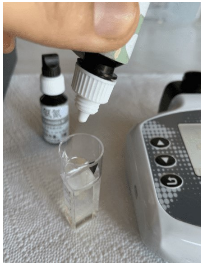
Figura 1.5 Medición de TAN amonio y amoniaco en biofloc. Imagen de Bioquafloc ©, todos los derechos reservados.
