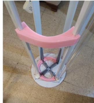
**Diseño e instalación de guías medias en marcos de focos UV-C.**
