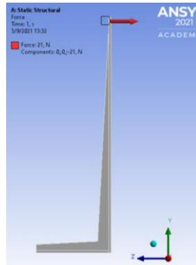
Figura 2.13 Aplicación de fuerza total  $F_T$  en el extremo superior del pie de amigo.
