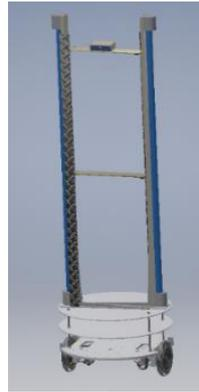
Figura 2.3. Segundo modelo de robot CoviBot usando platinas y soportes.
